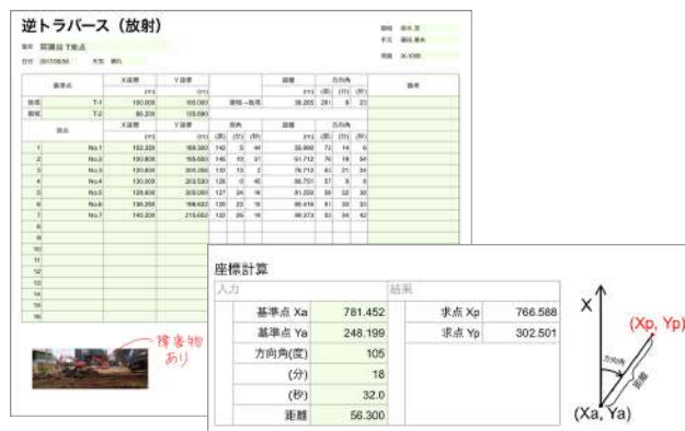
トラバース/逆トラバース放射計算、器高式水準測量、後方交会法、座標/方向角計算などのテンプレートを搭載
