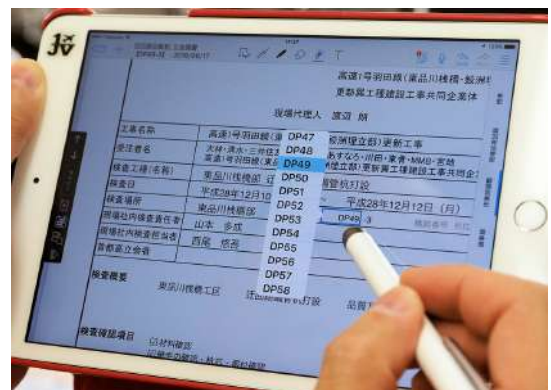
株式会社大林組JVで作成された検査報告書のフォーム 杭の番号はプルダウンメニュー化し、選択するだけで入力可能
