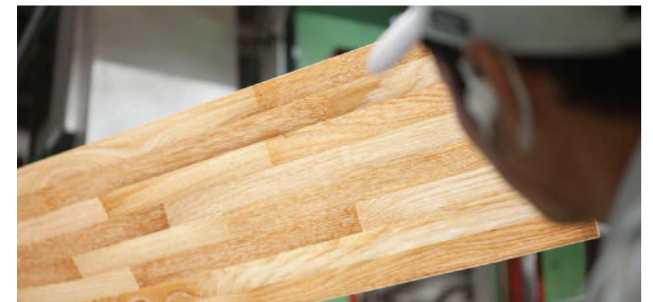
色のバラツキなど突き板の仕上がりを確認
