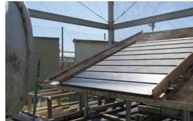
[実験条件] ●屋根面の風速:35m/s~60m/s(整流) ●試験時間:10分間 ●面積:1.95m 2 ●4寸勾配、流れ長さ2.5m
