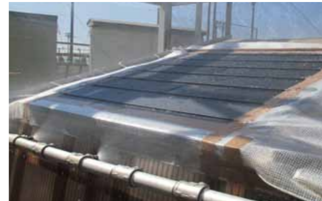
[実験条件] ●散水量:240mm/hr ●屋根面の風速:30m/s ●試験時間:10分間 ●面積:1.95m 2 ●4寸勾配、流れ長さ2.5m
