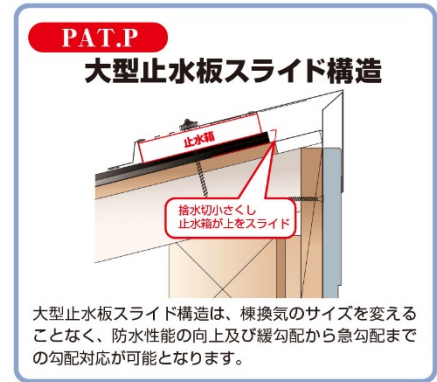
大型止水板スライド構造
