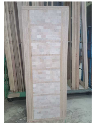
中央部分にバルサを充填した扉内部の様子
