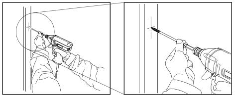
最初に、パネリード先端のドリル刃で下穴を開ける ネジ山が木材に食い付くまで、軽くインパクトドライバーを 回転させます。
