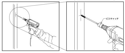
例.2) パネリード付属のビットを使用した場合 片方の手でパネリードを支え、打ち込み位置に狙いを定めます。
