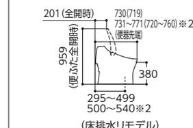
※右給水で既設の給水管に接続する場合は、フレキホース(別売品)TCA249 希望小売価格 ¥2,450が必要です。 ※1 壁排水(後ろ抜き)のリモデルの場合は、排水ジョイント(別売品)HP825 希望小売価格 ¥3,000が必要です。便器背面に約50mmすき間があります。排水高さの調整代は120±10mmです。 ※2 便器を前に出して施工した場合は、すき間が空き前出寸法が大きくなります。
