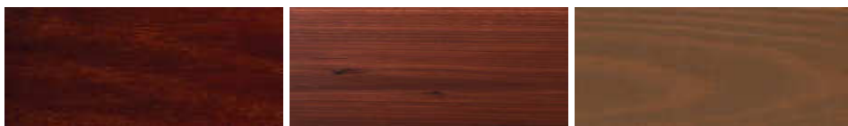
屋外用：原液2回塗り+ふきとりなし 色が入りにくい杉の赤身：原液1回塗り+ふきとり 木目つぶし：原液1回塗り+ふきとりなし
