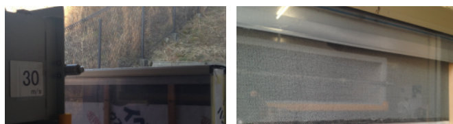
試験風景（風速30m/s、水量40l/min） 試験結果（躯体内部に漏水なし）
